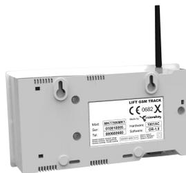
La instalación y puesta en marcha del equipo es muy simple. Lo primero que se debe hacer es taladrar dos agujeros en la pared y colocar los dos tacos y tornillos que se incluyen con el equipo. El MK-0775 sencillamente se cuelga en la pared. Necesitará una conexión de red de 230 VAC para alimentar el equipo. Finalmente conecte la salida de la línea telefónica local del equipo a su teléfono analógico.
